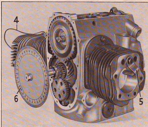
12. Gradscheibe (6) auf der Kurbelwelle befestigen (Gewinde M 12x1) und einen Zeiger (4) aus Draht so am Kurbelgehäuse befestigen, daß dessen Ende auf die Skala der Scheibe (6) zeigt.
