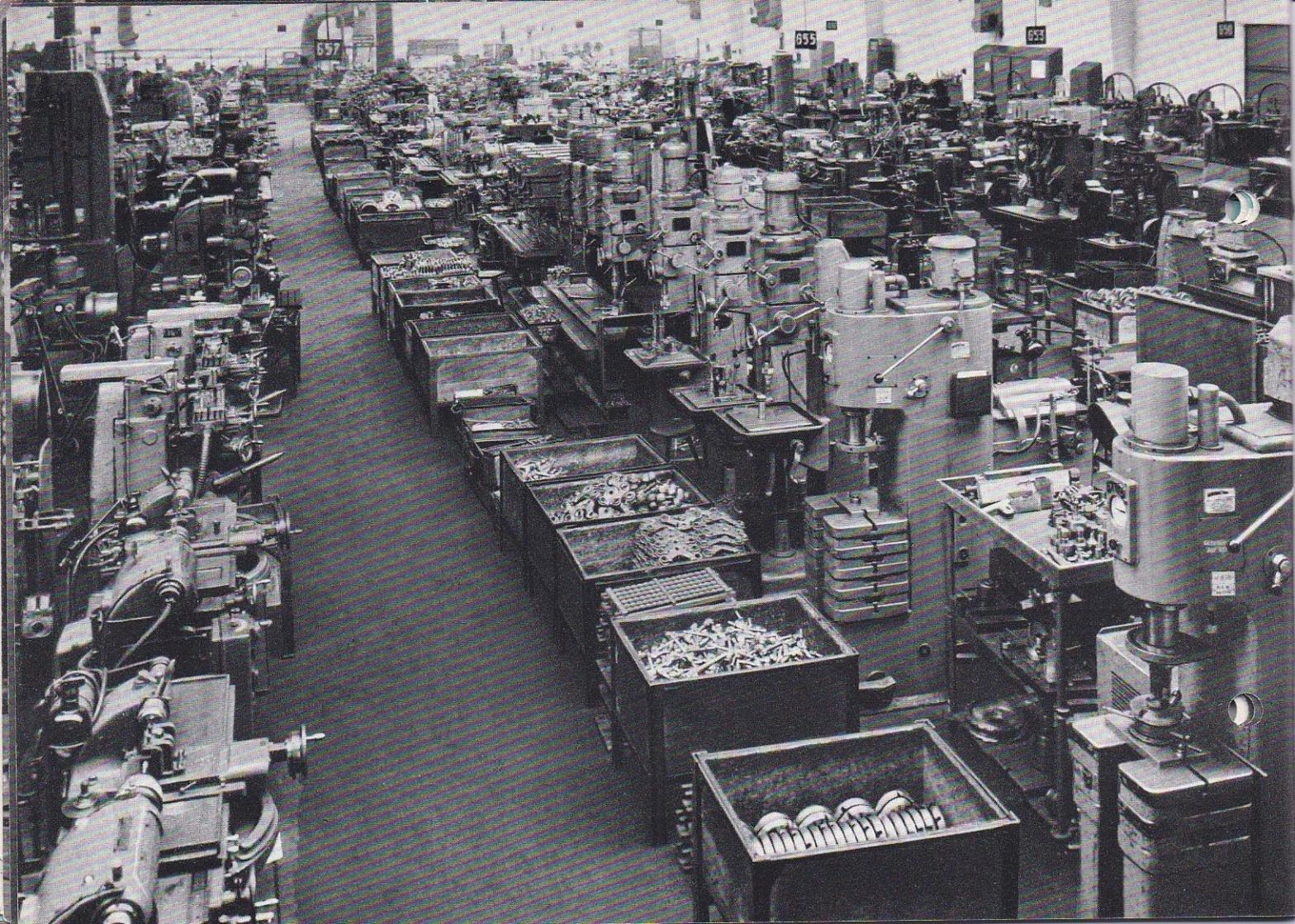
**Übersichtlich**, durch Fahrwege unterbrochen, stehen dicht beieinander die Bearbeitungsmaschinen. Um unnötige Transporte zu vermeiden und einen Fluß in der Arbeit bei gleichbleibenden Teilen zu erreichen, sind Fertigungsreihen angelegt, zum Beispiel Schwungscheiben-, Gehäuse- und Zylinderreihen.
