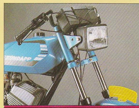
De hydraulisch gedempte voorvork met de robuuste, zwarte onderpoten en de onderhoudsvrije (chromo-molybdeen) binnenpoten, zorgen voor een stabiel en comfortabel rijgedrag.
