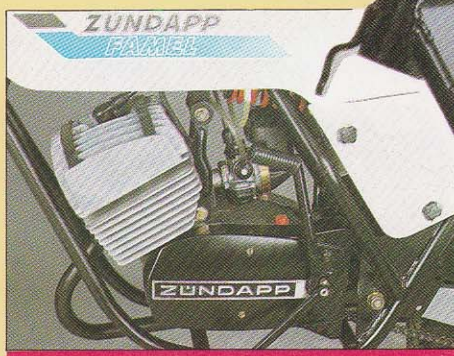
Het alom bekende Zundapp motorblok met kickstarter en vijf versnellingen. Achter het deksel bevindt zich de 12 Volts elektronische ontsteking.
