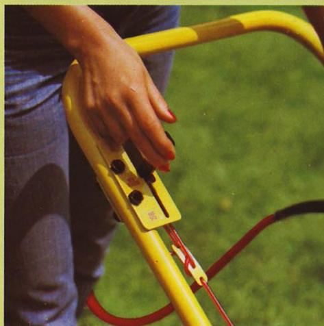
Das bedienungsleichte Schaltelement ist fest am Bügel montiert. Über ein Sicherheitszugseil werden Ein-/Aus-Schalter, Thermoschutzschalter und Sicherheitsbremse betätigt.
